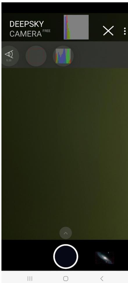
L'istogramma è molto utile soprattutto quando si scattano fotogrammi piatti. Il picco dell'istogramma di una cornice piatta dovrebbe essere nel mezzo. L'immagine sotto mostra un tipico flat frame con istogramma nel file browser interno di DeepSkyCamera.
